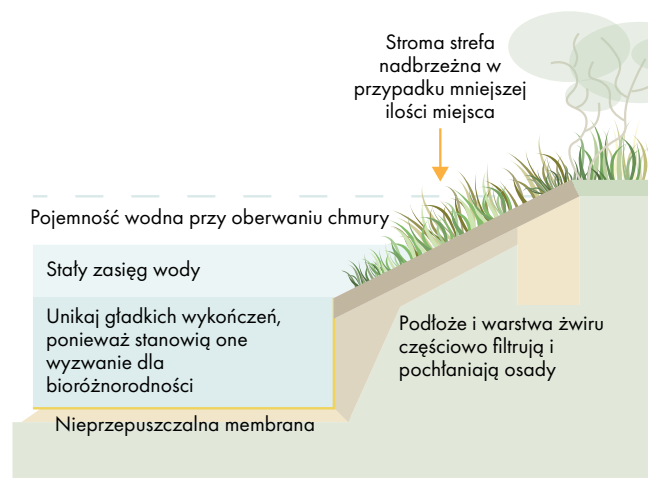
Rys. 26 - CLIMA-pond Obszary Miejskie (Urban design). Ta konstrukcja jest przeznaczona dla lokalizacji miejskich i koncentruje się przede wszystkim na magazynowaniu wody, przechwytywaniu zanieczyszczeń, minimalizowaniu produkcji gazów cieplarnianych i zapewnianiu korzyści w zakresie różnorodności biologicznej tam, gdzie to możliwe. © Amphi International ApS. Standard projektowy PONDERFUL dla stawów CLIMA jest opublikowany oddzielnie przez konsorcjum PONDERFUL . [33,34]
