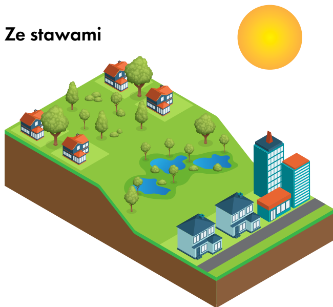
Rys. 10 - Uproszczona ilustracja korzyści zapewnianych przez małe oczko wodne zlokalizowane w zlewni obszaru miejskiego podczas burzy. Lewy rysunek przedstawia sytuację bez oczka wodnego, przed (na górze) i po (na dole) burzy. Prawy rysunek przedstawia tę samą sytuację, ale z korzyścią dla krajobrazu stawowego składającego się z trzech stawów o powierzchni 300 \text{ m}^2 ze strefą czerpalną, która jest w stanie zmagazynować 144 \text{ m}^3 wody deszczowej, zmniejszając ryzyko powodzi.
