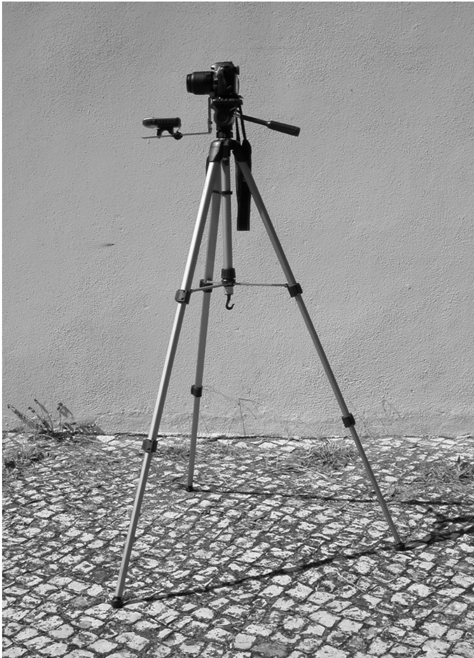
Figura 2 - Equipamento utilizado na obtenção das fotografias terrestres oblíquas
