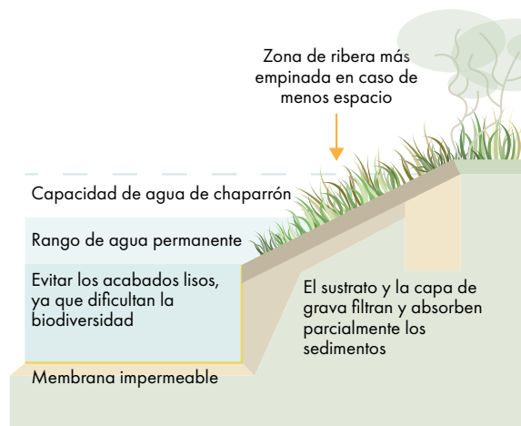
Fig. 26 - Diseño de una laguna CLIMA urbana. Este diseño es para ubicaciones en zona urbana que sobre todo busquen almacenar agua, retener contaminantes, minimizar la producción de gas de efecto invernadero y proporcionar beneficios a la biodiversidad cuando sea posible. © Amphi International ApS El consorcio PONDERFUL publica por separado las normas PONDERFUL para el diseño de lagunas CLIMA. [33,34]
