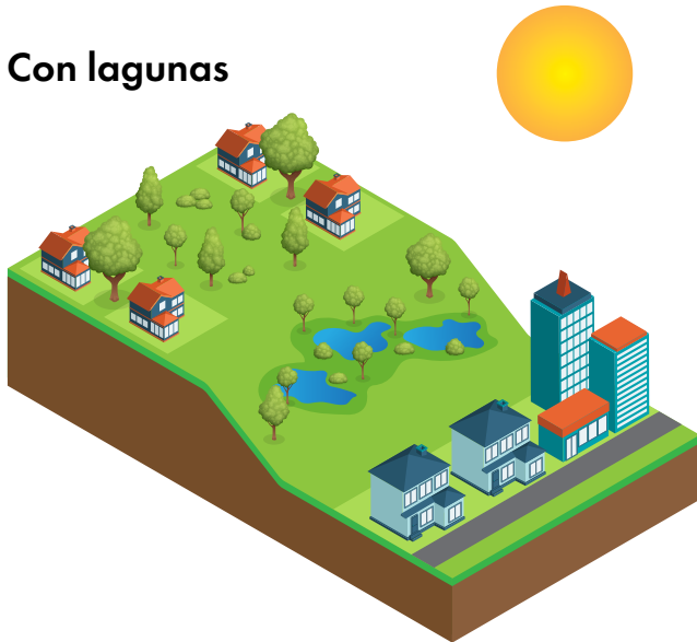
Fig. 10 - Ilustración simplificada del beneficio proporcionado por un pequeño paisaje de lagunas situado en la cuenca de drenaje de una zona urbana durante una tormenta. La figura de la izquierda muestra la situación antes (arriba) y después (abajo) de una tormenta sin el paisaje de lagunas. La figura de la derecha muestra la misma situación, pero con el beneficio de la presencia de un paisaje de tres lagunas de 300 m 2 con una capacidad de acumular hasta 144 m 3 de agua de lluvia, reduciendo así el riesgo de inundación.
