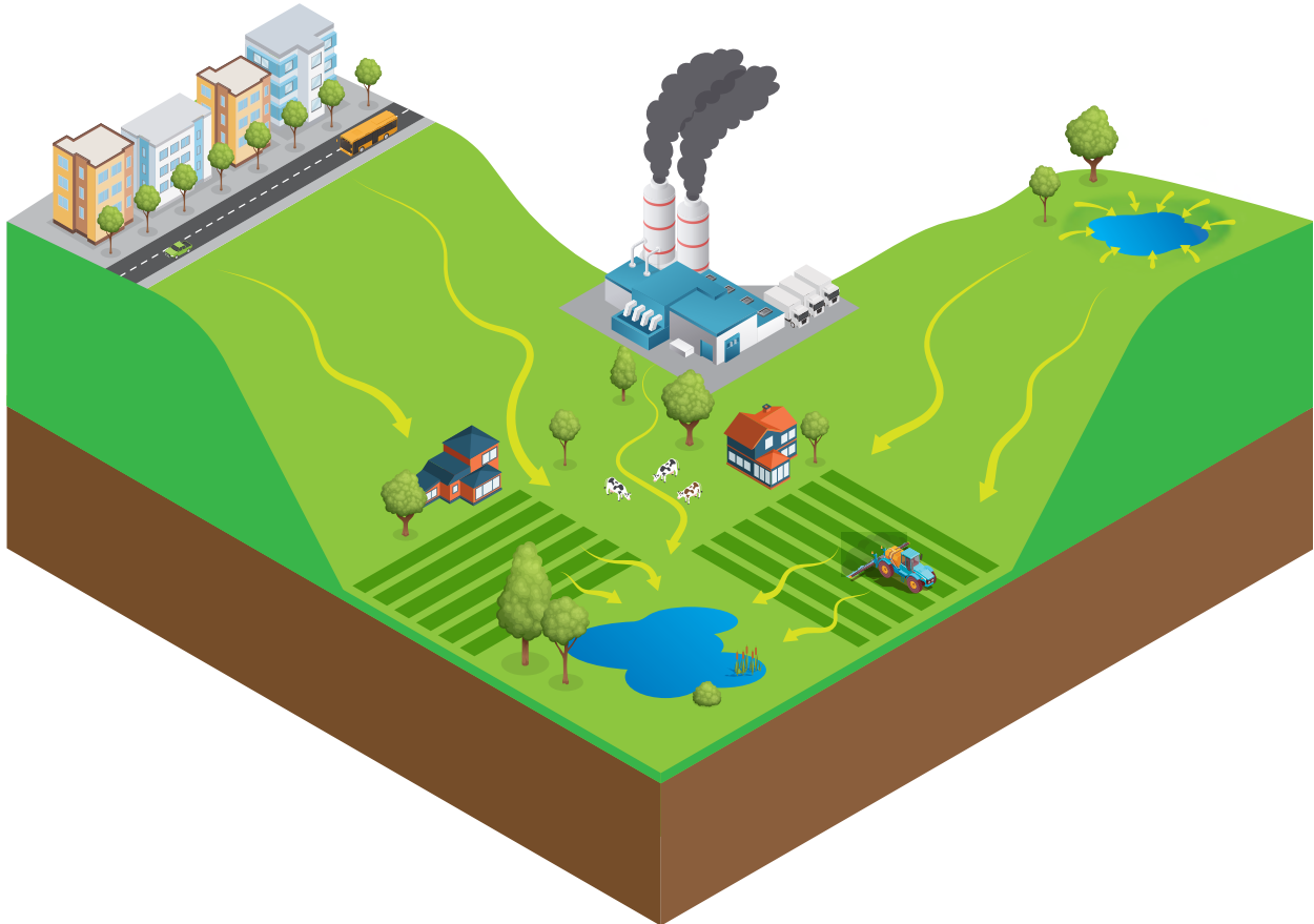
Fig. 18 - Comprendere il bacino idrografico di uno stagno è importante per definire l'ubicazione e il design di nuovi stagni e per individuare da dove potrebbe provenire la fonte d'inquinamento dell'acqua.
