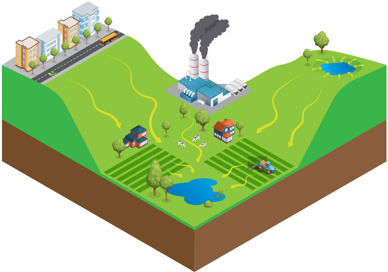
Rys. 18 - Zrozumienie zlewni stawu jest istotne, aby określić lokalizację i projekt nowych stawów, a także zrozumieć, skąd może pochodzić zanieczyszczenie wody.
