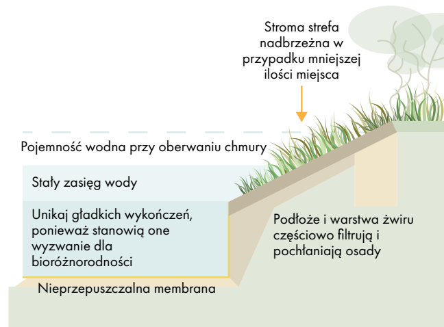
Rys. 26 - CLIMA-pond Obszary Miejskie (Urban design). Ta konstrukcja jest przeznaczona dla lokalizacji miejskich i koncentruje się przede wszystkim na magazynowaniu wody, przechwytywaniu zanieczyszczeń, minimalizowaniu produkcji gazów cieplarnianych i zapewnianiu korzyści w zakresie różnorodności biologicznej tam, gdzie to możliwe. © Amphip International ApS. Standard projektowy PONDERFUL dla stawów CLIMA jest opublikowany oddzielnie przez konsorcjum PONDERFUL . [33,34]
