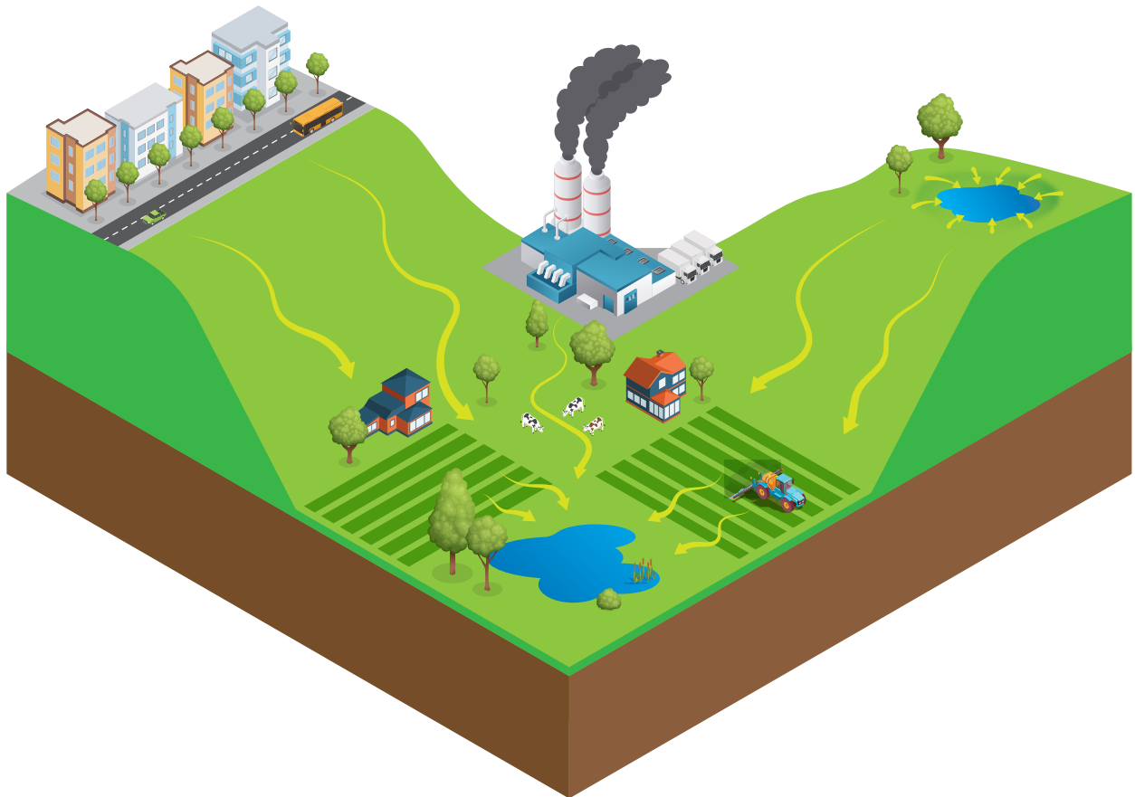
Figur 18 - Att förstå en damms avrinningsområde är viktigt för att informera om placeringen och utformningen av nya dammar och för att förstå var vattenföroreningar kan komma ifrån.
