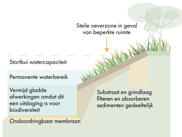
Fig. 26 - CLIMA-poel in stedelijk gebied: Dit ontwerp is bedoeld voor stedelijke locaties en richt zich voornamelijk op wateropslag, het opvangen van vervuiling, het minimaliseren van de productie van broeikasgassen en waar mogelijk het behoud van biodiversiteit. © Amphi International ApS De PONDERFUL ontwerpstandaarden voor CLIMA-poelen wordt apart gepubliceerd door het PONDERFUL consortium. [33,34]
