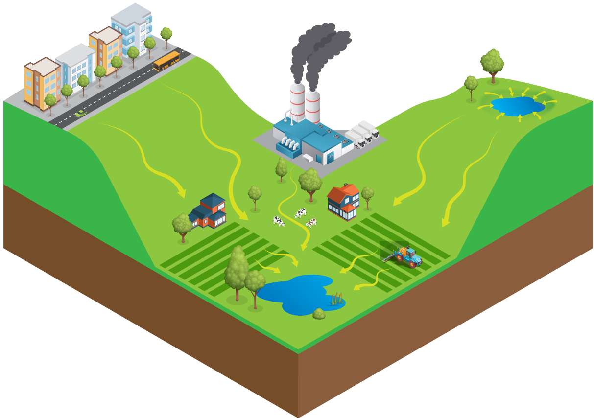
Fig. 18 - Forståelse af et vandhuls opland er vigtig for at afgøre placeringen og udformningen af nye vandhuller og for at bestemme, hvor vandforureningen stammer fra. Det forurenede vand (gul pil) opfanges af det første velbeplantede vandhul, hvorefter det strømmer ind i et andet og tredje vandhul. Det rensede vand (blå pil) flyder derefter nedstrøms mod pondscapet, hvor det vil forsyne andre vandhuller med vand.
